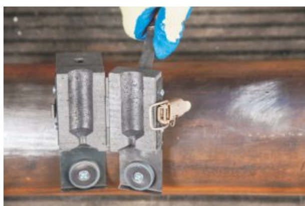
Многогранная тигель-форма МТФ-НГК перед установкой на трубу
