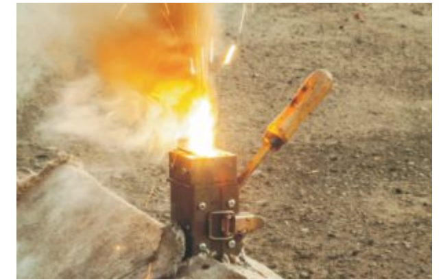
Процесс горения термитной смеси
