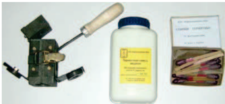
Фото 1. Термосмесь, многоразовая тигель-форма, термитные спички
